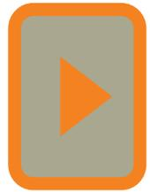
**SUBIR RPM:** presionando este botón, subimos en forma continua las RPM. El valor máximo es de 3.999RPM.
